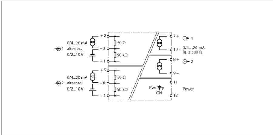
Les signaux de tension ou de courant actifs normalisés sont séparés galvaniquement par le séparateur de signaux analogiques mono-canal IM31-22-I et ensuite transmis.
