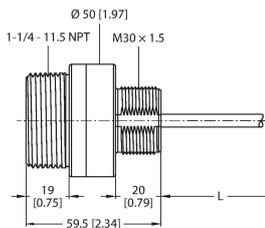
Détecteur ultrasonique, bouton-poussoir à réflexion, portée 3 m, interface série pour le raccordement aux nœuds DX80
