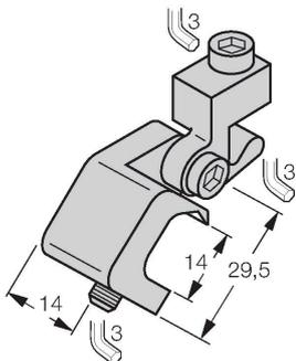
Pièce de serrage pour le montage de détecteurs de champs magnétiques sur vérins avec tirants ; diamètre du vérin 40...125 mm ; matériau : Aluminium
