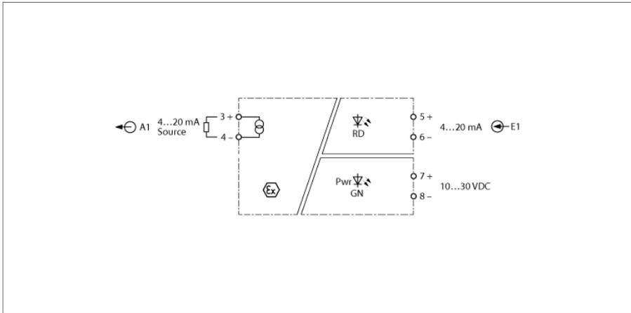
Le signal de courant normalisé est séparé galvaniquement de 1/1 par le séparateur de signaux monocanal IMXK12-AO01-1I-1I-H0/24VDC de la zone non-Ex à la zone Ex. Sauf le signal analogique il est également possible de transmettre bidirectionnellement les signaux numériques de la communication HART®. Des applications typiques sont la commande de convertisseurs I/P ou d'appareils d'affichage dans la zone Ex.
