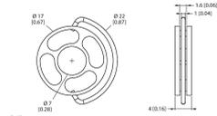
Estrella centradora de politetrafluoroetileno (PTFE) para el montaje de sondas en la serie de productos LS-5 en tubos coaxiales LSCT-xx-xxxx.
