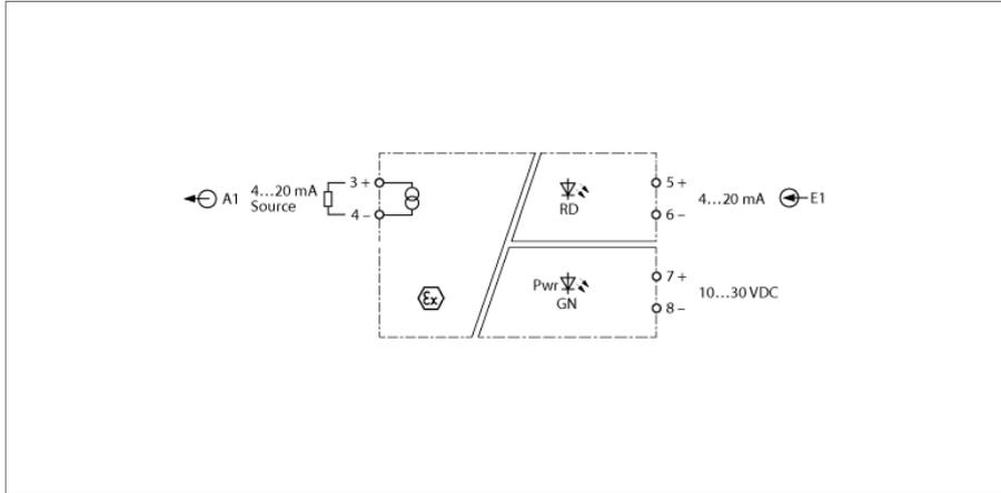
El separador de señal de 1 canal IMXK12-AO01-1I-1I-H0/24VCC transmite la señal de corriente normalizada, y aislada galvánicamente en una relación 1:1 desde la zona no Ex a la zona Ex. Además de la señal analógica, las señales de comunicación digitales HART® también se pueden transmitir bidireccionalmente. Aplicaciones típicas son la activación de convertidores I/P o en equipos de indicación en zonas Ex.
