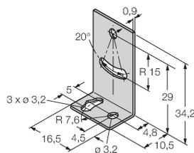
Montagewinkel; Werkstoff VA 1.4401, für Optosensor Bauform Q12
