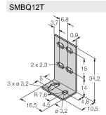
3073722 Montagewinkel; Werkstoff VA 1.4401, für Optosensor Bauform Q12
